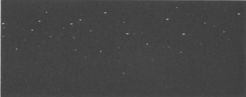
Abb. 1. Weissenberg-Aufnahme von  $\text{Na}_2\text{H}_2\text{GeO}_4 \cdot 6 \text{H}_2\text{O}$ , um  $[010]$  gedreht, Äquator, Cu-K $\alpha$ -Strahlung.
